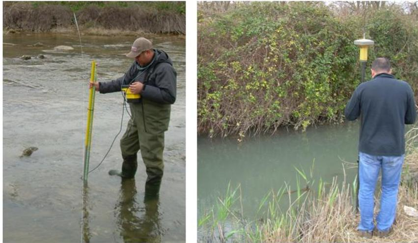
Figura 7. Medición en campo de la hidrometría con molinete electromagnético en un tramo vadeable del río Júcar. Levantamiento topográfico mediante GPS de uno de los perfiles transversales aforados
