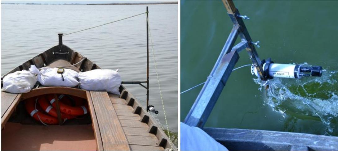
Figura 45. Disposición de los CTs en la embarcación para la obtención de registros de temperatura y CE en continuo a dos profundidades diferentes
