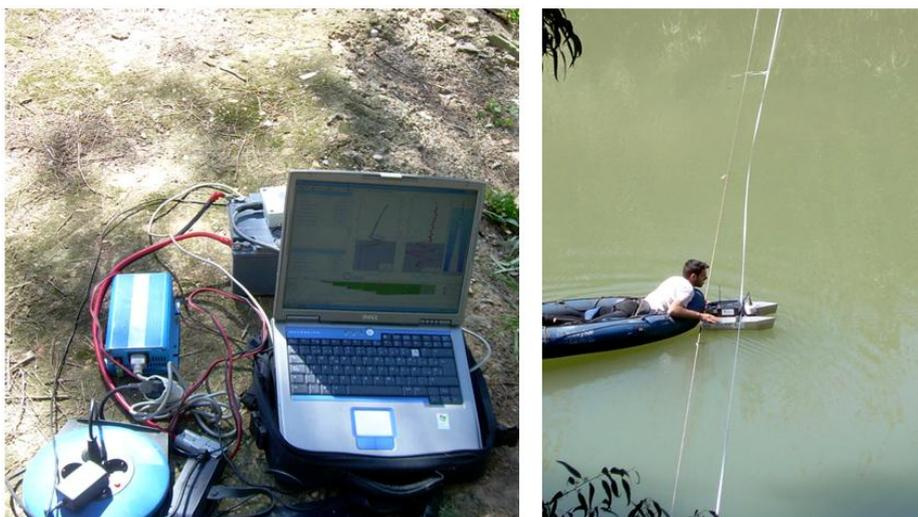
Figura 8. Medición en campo de la hidrometría con el doppler acústico, en un tramo no vadeable del río Júcar
