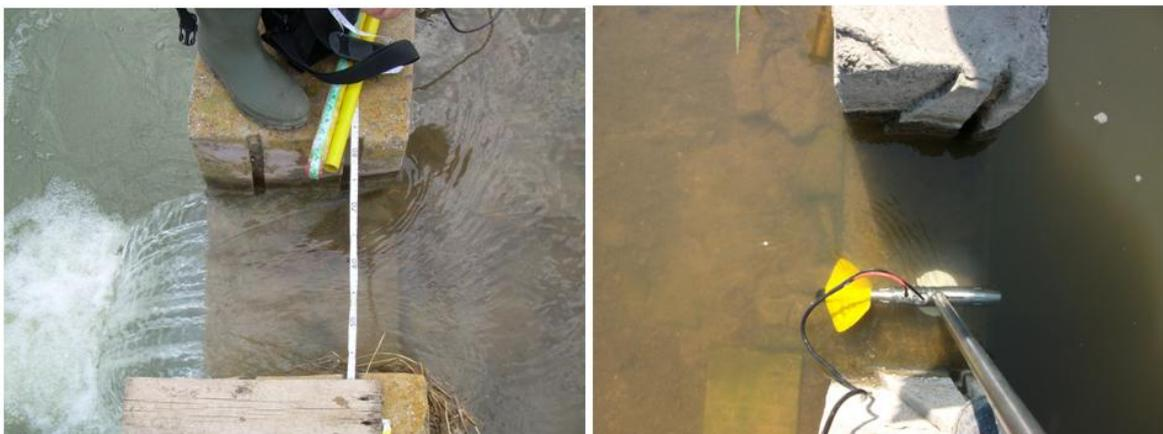
Figura 21. Medición de secciones y velocidades mediante molinete de hélice en entradas y salidas para calcular posteriormente los caudales de entrada y salida
